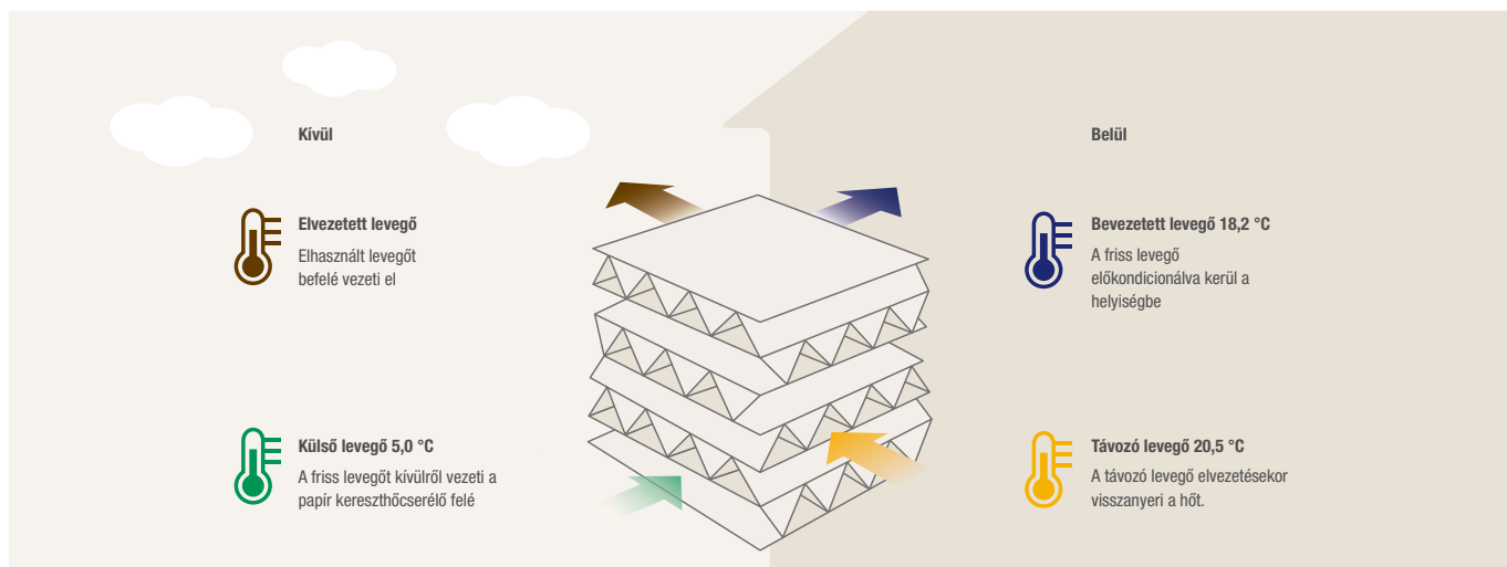
A Lossnay papír kereszt hőcserélő felépítése
